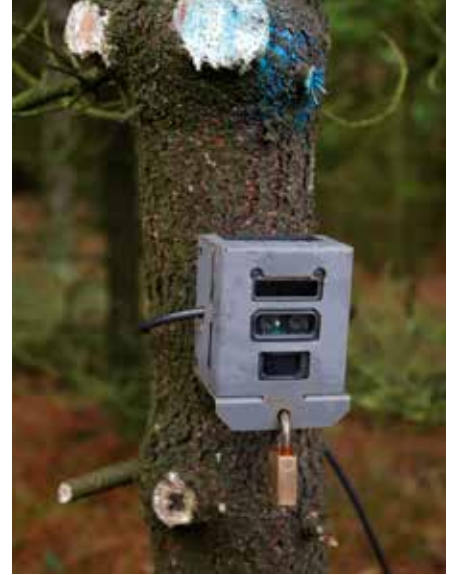
Desværre har de frivillige indsamlere flere gange oplevet hærværk eller tyveri af vildtkameraerne, så derfor er de nu sikret bedst muligt. Denne er simpelthen låst inde i en stålkasse.
